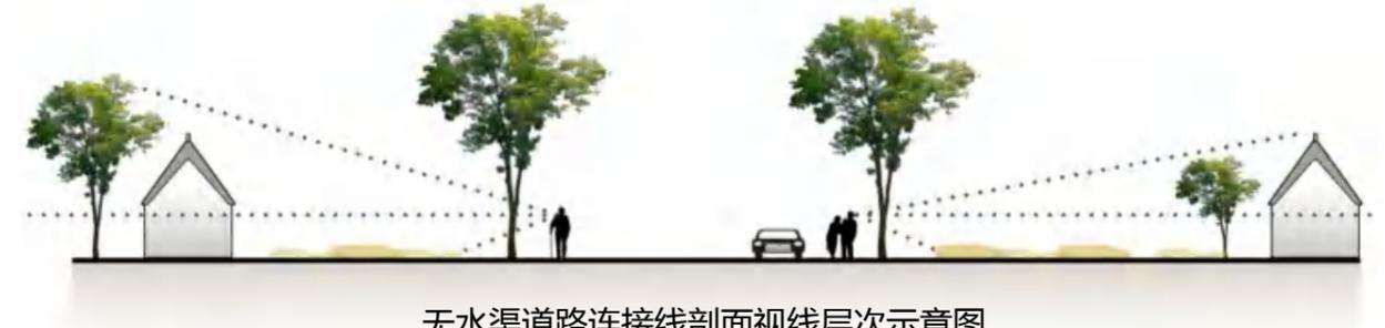
无水渠道路连接线剖面视线层次示意图
