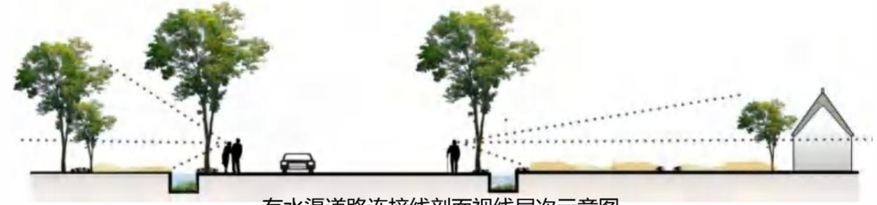
有水渠道路连接线剖面视线层次示意图
