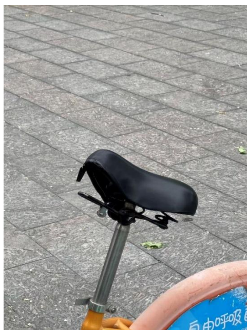
图 7 黎明龙门公共自行车站点车座损坏
